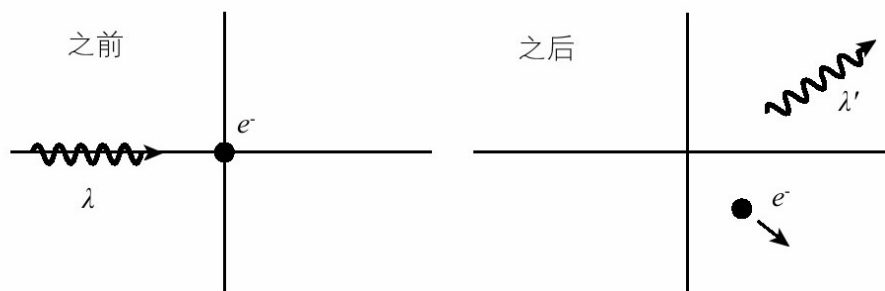
图6-2 康普顿散射。在康普顿散射里，一个光子（ \lambda ）击中一个静止的电子（ e^- ）而产生散射，并表现为不同的能量和动量。
