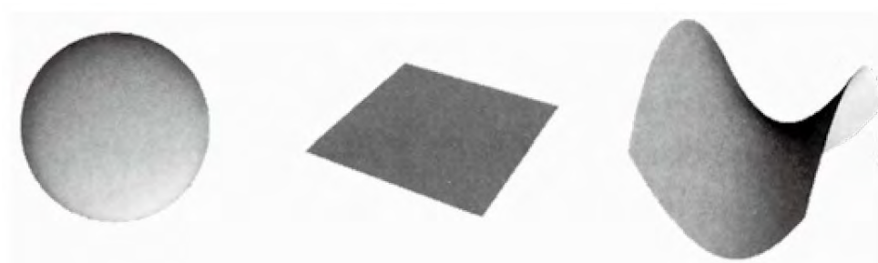
图5-4 正弯曲、零弯曲和负弯曲的表面。
