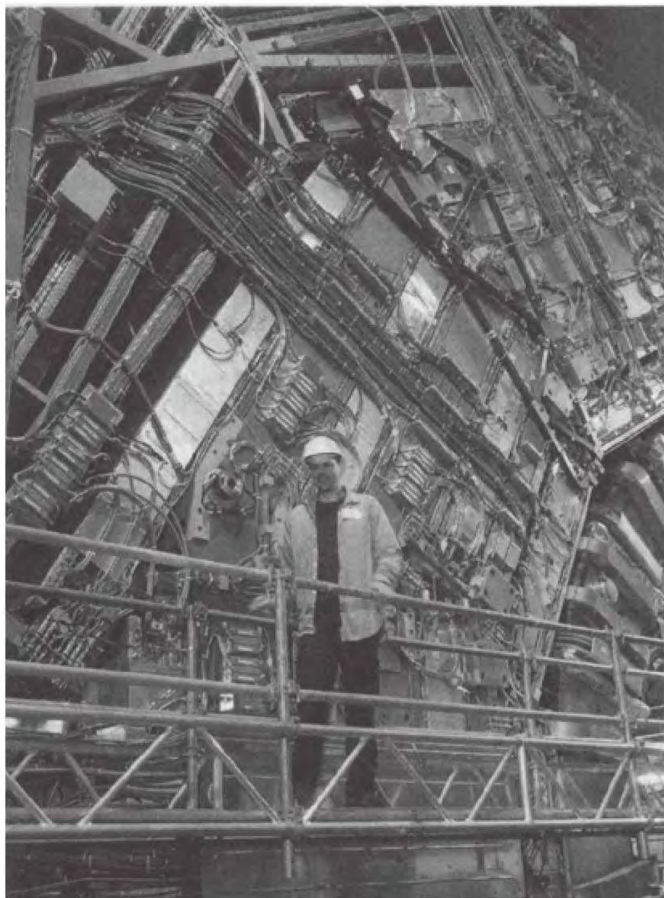
图13-2 我的合作者吉拉德·佩雷斯站在一层层的紧凑 \mu 子线圈 \mu 子探测器/磁返回轭前面。
