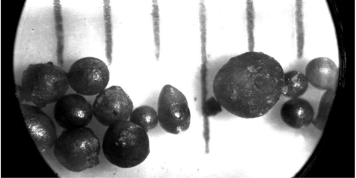
图5-4 散开的粒状体的显微镜影像。每两个刻度间的距离为1毫米（图片来源：Vatican Observatory, Guy Consolmagno）
