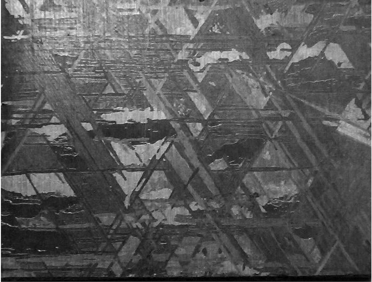
图5-3 吉丙 (Gibeon) 铁陨石的一小块样本，经酸蚀和打磨后，可以看到它的网格状的晶体结构，这种纹路被称为维德曼交角花纹。此样本的宽度为4厘米（图片来源：J. Mitton）
