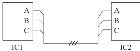
图 2-9 连接导线的简化画法
