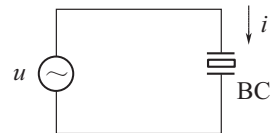
图 5-171 晶体的工作原理
