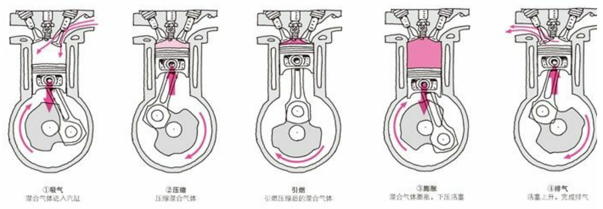
图2.2 四冲程发动机 ※重复进气、压缩、膨胀、排气四个行程
