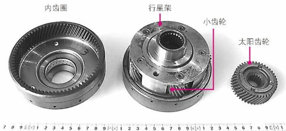
照片3.1 行星齿轮 ※左边是内齿圈，中间是装在行星架中的小齿轮，右边是太阳齿轮。照片由加特可提供。
